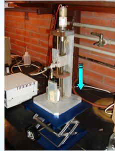
Inmersión del sustrato (portaobjeto) en el sol precursor ( \text{TiO}_2 )
